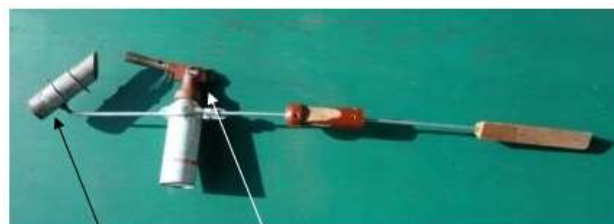
バーナーは市販品 足場組み用単管（外径48.6ミリ）を42ミリに小さくした
